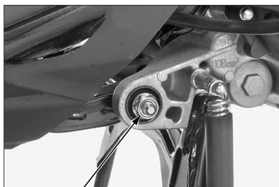
PORCA/PARAFUSO DA ARTICULAÇÃO DE SUPORTE DO MOTOR
