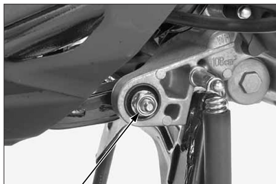
PORCA/PARAFUSO DA ARTICULAÇÃO DE SUPORTE DO MOTOR
