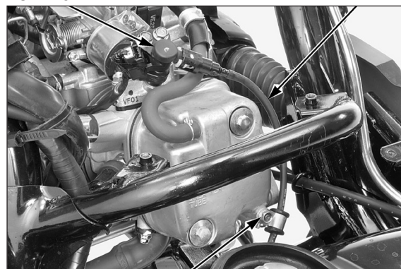
PARAFUSO DA BRAÇADEIRA DA MANGUEIRA DE COMBUSTÍVEL
