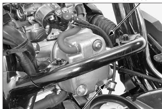
PARAFUSO DA BRACADEIRA DA MANGUEIRA DE COMBUSTÍVEL
